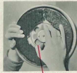
De viltschijf wordt door middel van een klemveer op de borstel bevestigd. Hiermee kan de vloer nog eens extra worden nagewreven.
