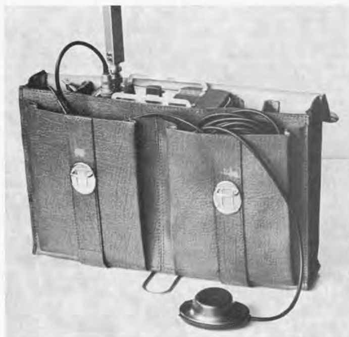
De marifoon in tas, zoals de loods hem meeneemt. Door de uitklapbare voetbeugel kan het geheel rechtop staan.
