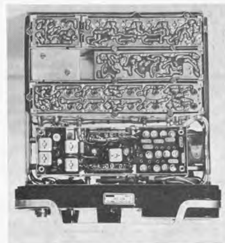
Het inwendige van de HTC 3307. Het apparaat is opgebouwd uit gedrukte schakelingen, die aan twee zijden van een frame zijn aangebracht.
