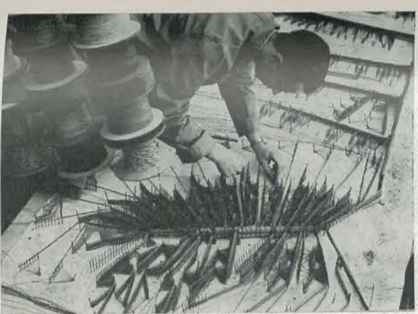
De draaddomen voor het hart van een communicatienet, de centrale, worden met de hand vervaardigd.
