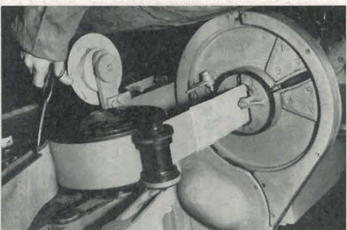
Machine om tussen de beide staal-draahtroepen van de Solex-buitenband het canvas aan te brengen (zelfde principe als bandlagermachine statorspoelen in fabriek Utrecht).
