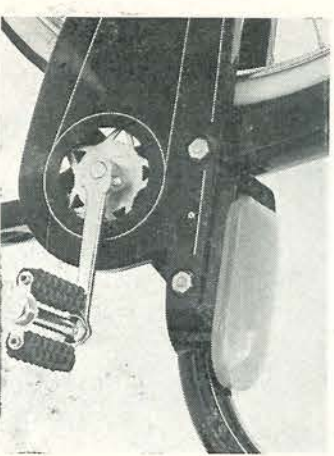
Hierboven: Deze gereedschapsruimte is in drie vakjes ingedeeld, zodat behoudens sleutels ook banden-reparatie-middelen etc. kunnen worden meegenomen.
