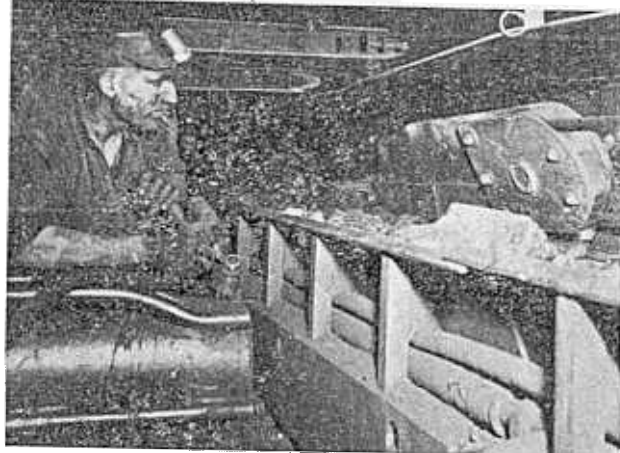
De Kolenschaaf, door de mijnwerkers meestal Kolenploeg genoemd, in gebruik.
