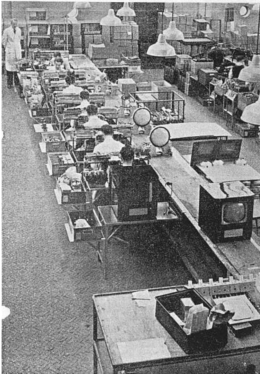
De montage van televisie-toestellen in onze fabriek Maanweg
