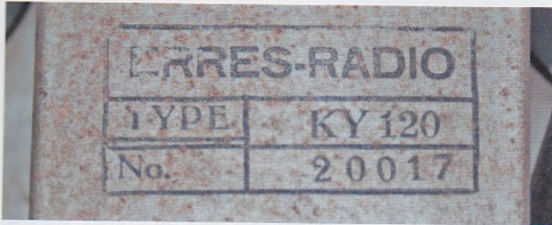
Stempel op het huis van de afstemcondensator van een Erres KY120 met het serienummer 20017.
