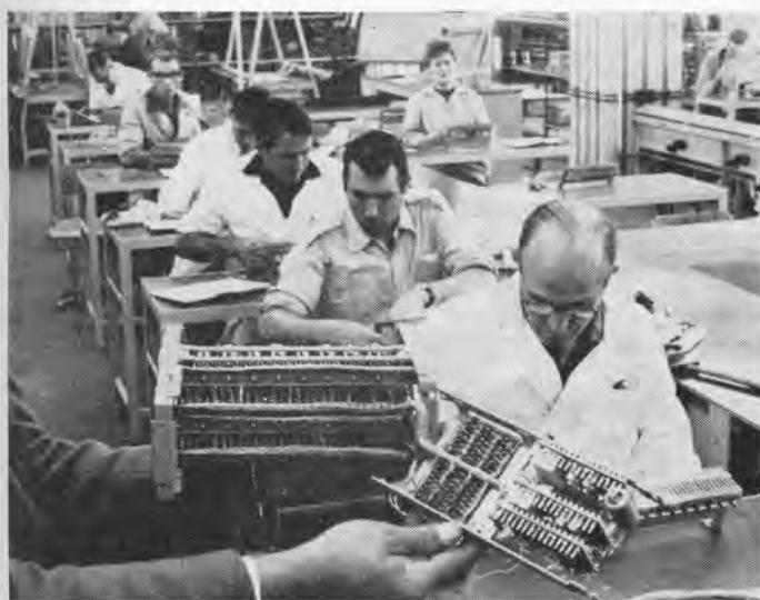
Steeds meer mensen worden ingezet voor het nieuwe project: het vervaardigen van units voor telefooncentrales. Op de voorgrond ziet u zo'n unit.
